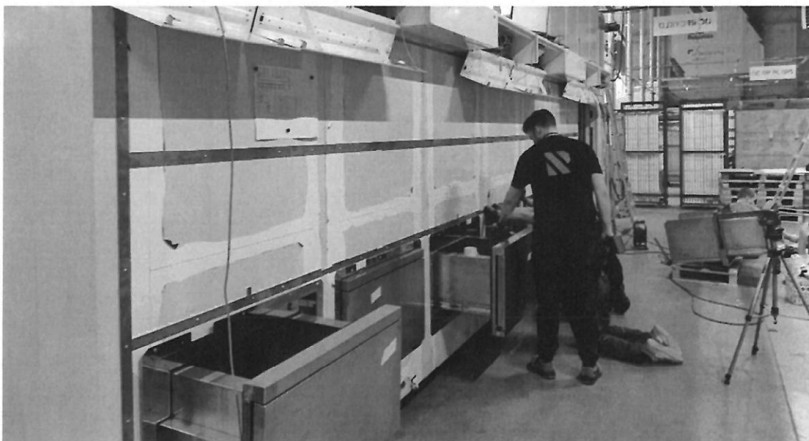
Rys. 14 – Montaż śluz nadawczo-odbiorczych w prototypie nr 2
